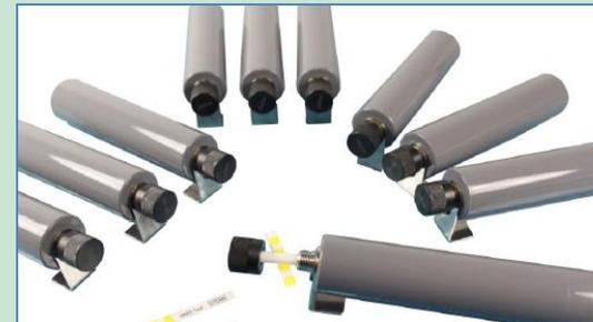
Die Prüfkörper (beide Bauarten) haben unterschiedliche Geometrie und stellen deshalb verschiedene Schwierigkeitsgrade der Durchdringung mit Sterilisationsmedium dar.
